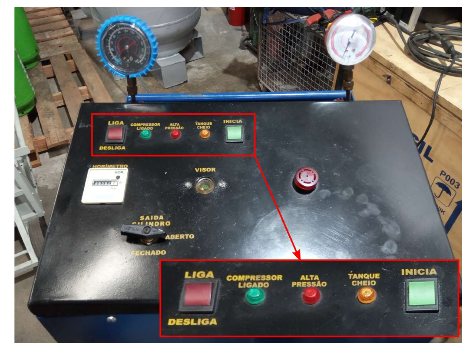
Figura 3. Painel da máquina recicladora de gás.
