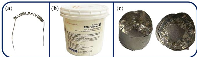
Figura 2: Em (a) filamento de níquel cromo utilizado para confeccionar a resistência, em (b) cerâmica em pó que quando misturada com água, após a cura, se torna rígida, em (c) o invólucro que tem a função de criar uma forma de prender a cerâmica no manipulador, além de ser o responsável por transferir o calor para a amostra.
